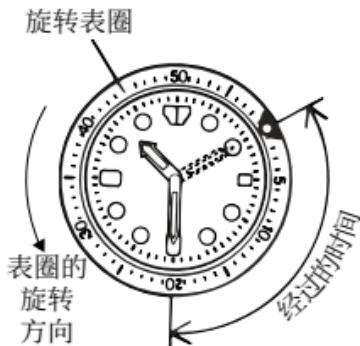
指示外环不能逆向转动，并具有保护机构来防止外力和碰撞的误操作。外环上数字也有助于您轻松地读取精确的时间。
