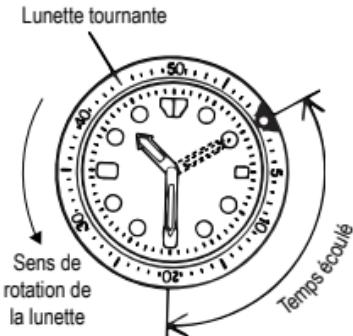
Vous ne pouvez pas tourner la lunette dans le sens inverse car elle est dotée d'un mécanisme de protection empêchant tout actionnement incorrect par la force ou un choc. Les chiffres sur la lunette peuvent également vous aider à lire l'heure actuelle plus facilement.
