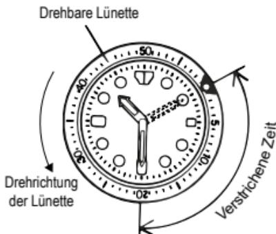
Sie können die Lünette nicht rückwärts drehen, da sie mit einem Schutzmechanismus gegen Fehlbedienung durch Gewalteinwirkung oder Erschütterungen ausgestattet ist. Die Angaben auf der Lünette können auch zum leichten Ablesen der aktuellen Uhrzeit helfen.
