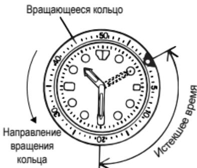
Кольцо не может поворачиваться в противоположном направлении, поскольку оно оснащено защитным механизмом, предназначенным для защиты от ошибочной операции в результате приложения силы или удара. Цифры на вращающемся кольце также могут упрощать считывание текущего времени.
