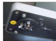
O mecanismo AcuGrip foi especialmente projetado para o Discproducer™ da Epson. Ele assegura que o braço robotizado pegue sempre um disco de cada vez, mesmo quando estejam grudados. O AcuGrip aumenta a durabilidade do robô e evita surpresas desagradáveis, como por exemplo, uma produção rodada à noite sem supervisão seja interrompida por causa de um bloqueio mecânico no braço.
