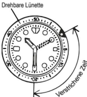
Sie können die Lünette nicht rückwärts drehen, da sie mit einem Schutzmechanismus gegen Fehlbedienung durch Gewalteinwirkung oder Erschütterungen ausgestattet ist. Die Angaben auf der Lünette können auch zum leichten Ablesen der aktuellen Uhrzeit helfen.
