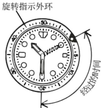
指示外环不能逆向转动，并具有保护机构来防止外力和碰撞的误操作。外环上数字也有助于您轻松地读取精确的时间。
