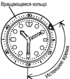
Кольцо не может поворачиваться в противоположном направлении, поскольку оно оснащено защитным механизмом, предназначенным для защиты от ошибочной операции в результате приложения силы или удара. Цифры на вращающемся кольце также могут упрощать считывание текущего времени.
