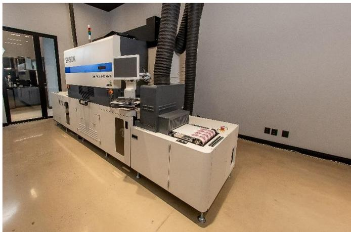
A empresa também promoverá a inovadora [SurePress L-6534VW](#), impressora digital industrial para etiquetas e rótulos, em alta velocidade e equipada com mecanismo avançado de fixação da tinta LED UV e opcionais de tinta branca e verniz digital, que elevam as
